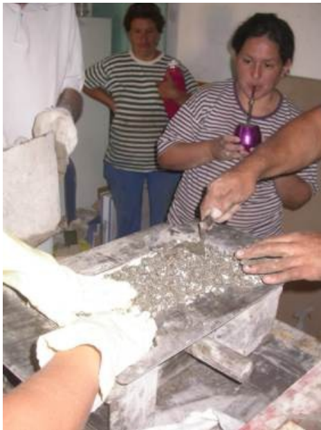
Imágenes 33 y 34 Producción y fragüe del Bloque H al pie de obra
